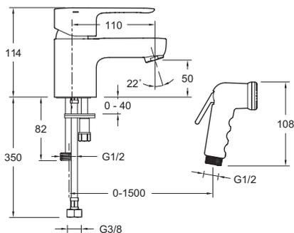
Спецификация продукта : Смеситель для раковины. E16319-4. Коллекция : JULY. МАТЕРИАЛ : N/A. ТИП УСТАНОВКИ : 1 отверстие. TYPE : Однорычажный. HAUTEUR TOTALE DU ROBINET (MM) : 50 мм. SAILLIE DU BEC (MM) : 110 мм. VIDAGE : С донным клапаном. GARANTIE FINITION : 10 лет.
