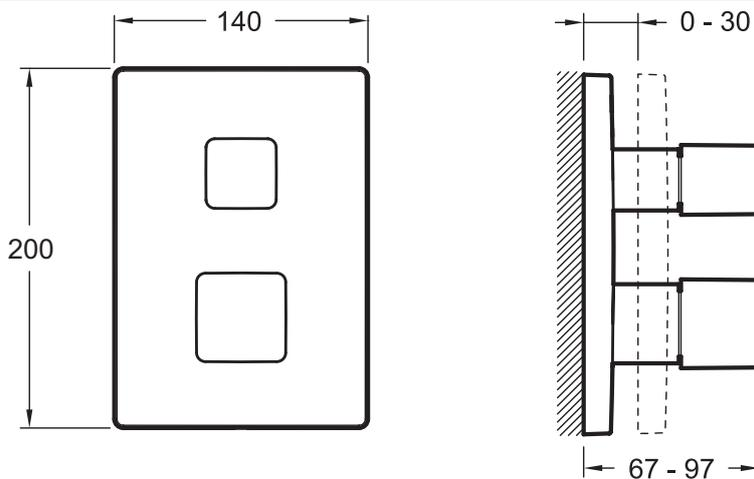
Спецификация продукта: Термостатический смеситель на 1 выход. E98729. Коллекция: MODULO. ВЕС: 3,1 кг. Встроенное выпускное отверстие. Запорный кран 1/4.
